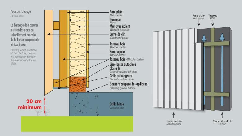
La pose verticale doit se faire sur un double réseau perpendiculaire de tasseaux pour assurer une parfaite ventilation du bardage
